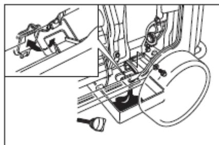
**NAPOMENA:** NEMOJTE naginjati generator pri dodavanju motornog ulja. Ovo može rezultirati prepunjnjem i oštećenjem motora.
