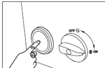
3. Pritisnite i otpustite dugme prekidača za pokretanje. Prekidač za pokretanje će pokrenuti motor na 5 sekundi. Kada se motor uspješno pokrene, starter će se automatski zaustaviti. Ako se motor ne pokrene uspješno, pričekajte najmanje 10 sekundi prije ponovnog pokretanja.
